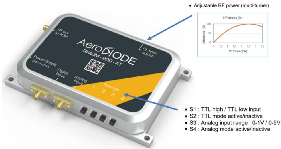
Figure 2 : Model RFAOM-TA-200 S1-S4 settings
